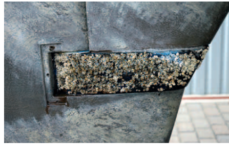
Wirklich wirksame Beschichtung. Dagegen ist der Bronzeschuh des Ruderlagers trotz des alten Antifouling-Anstrichs stark bewachsen
